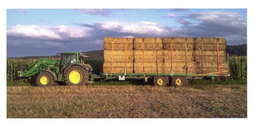
Durch die ausziehbare Verlängerung kann die Ladefläche der Ladung entsprechend angepasst und damit die Transportkapazität optimiert werden. Bilder: Beck, Burgdorf
