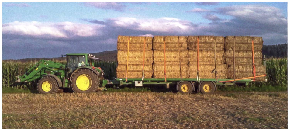
Durch die ausziehbare Verlängerung kann die Ladefläche der Ladung entsprechend angepasst und damit die Transportkapazität optimiert werden. Bilder: Beck, Burgdorf
