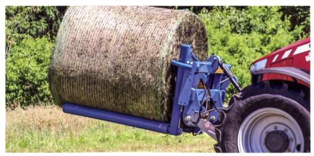
So nicht auf der Strasse! Allerdings bei Leerfahrten auf der Strasse darf die Ballengabel an der Traktorfront mitgeführt werden, wenn diese ausreichend gekennzeichnet und der vordere Überhang von 4m eingehalten wird (ab 3 m Überhang benötigt es einen V-Spiegel). Für Transport mit Ballen auf der Strasse muss die Ballengabel am Heck mitgeführt werden, zudem sind die Ballen mit Spannsets zu sichern, und es ist darauf zu achten, dass die Beleuchtung nicht verdeckt wird. Bilder: Ruedi Hunger
