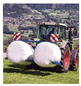
Sowohl die Ladungssicherung als auch die Beleuchtung sind korrekt. Jedoch wird die zulässige Gesamtbreite von 2,55 m mit grösseren Ballen überschritten, damit sind Strassenfahrten nicht mehr gestattet. Die Nutzlast des Traktors darf nicht überschritten werden.
