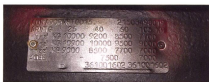
Auch die Bremsen von 30-km/h-Anhängern müssen Mindestanforderungen erfüllen. Bilder: SVLT-ZH
