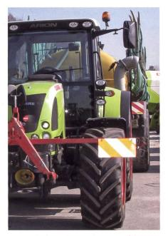
Die Breite der Anhänger ist am Zugfahrzeug auffällig zu markieren; das ermöglicht die Einschätzung der Fahrzeugkombination.
