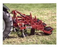
Maschine kann auch im Herbst zur Mäusebekämpfung eingesetzt werden. Dazu werden die entstehenden Öffnungen im Boden nicht wie üblich geschlossen, was den Frost bis in tiefere Bodenschichten vordringen lässt und zusätzlich die Bauten der Mäuse zerstört.
