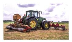
des oberen. Diese Rolle regelt auch die Tiefe. Die Agri-Serie kann optional für raues Gelände mit einer Packerringe-Rolle ausgestattet werden. Bei verfilzten Beständen sollte für ein gutes Resultat vorgängig gestriegelt werden, damit die Pflanzen Licht und Wärme erhalten.
