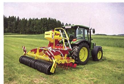
sogenannte «Full Edition» sind die Maschinen mit pneumatischem Sägerät mit Breitsatrablage neben einer Beleuchtung auch mit einer sicheren Befülltreppe, mit einem elektrischen Gebläse inkl. Steuermodul sowie mit einem Sensorset aus Radar- und Hubwheelsensor ausgerüstet.
