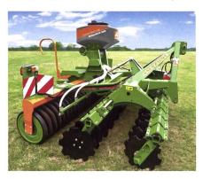
das Saatgut über Schläuche zu Pralltellern gefördert und von dort unmittelbar vor oder hinter der Walze der Bodenbearbeitungsmaschine ausgebracht.
