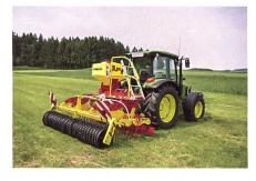
sogenannte «Full Edition» sind die Maschinen mit pneumatischem Sägerät mit Breitsaatablage neben einer Beleuchtung auch mit einer sicheren Befülltreppe, mit einem elektrischen Gebläse inkl. Steuermodul sowie mit einem Sensorset aus Radar- und Hubwerksensor ausgerüstet.
