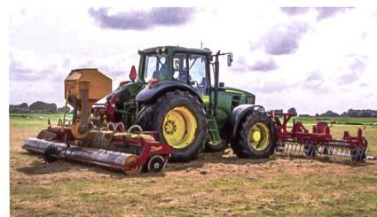
des oberen. Diese Rolle regelt auch die Tiefe. Die Agri-Serie kann optional für raues Gelände mit einer Packerring-Rolle ausgestattet werden. Bei verfilzten Beständen sollte für ein gutes Resultat vorgängig gestriegelt werden, damit die Pflanzen Licht und Wärme erhalten.
