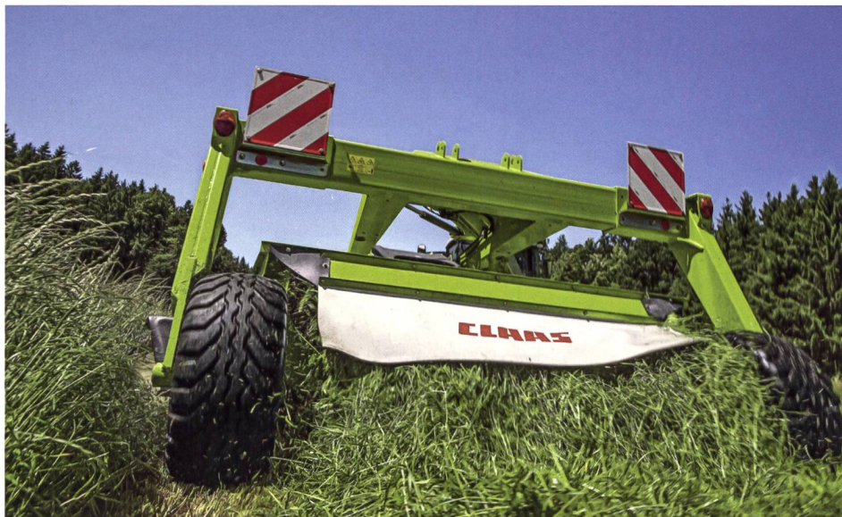
Bei richtiger Einstellung verursacht nicht in erster Linie der Aufbereiter Blattverluste, wohl aber der nachfolgende Durchgang mit dem Kreiselzettwender, weil dann angeschlagene Blättchen abfallen. Luzerne ist besonders gefährdet. Bild: Claas
