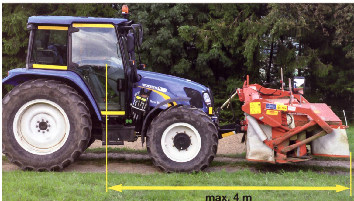
Der maximal zulässige vordere Überhang von 4 m ist mit laufend grösser und schwerer werdenden Traktoren und Geräten kaum mehr einzuhalten. Bild: BUL
