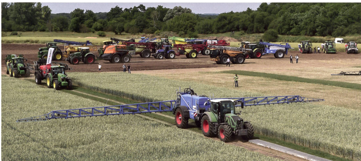
An Feldtagen wird das Schwingverhalten von Spritzgestängen publikumswirksam vorgeführt. Dieser optische Eindruck ist aber völlig ungenügend um abzuklären, wie gross die tatsächlichen Schwingungen am Gestängeende wirklich sind. Bild: Pfortner
