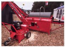
Antriebsaggregat für zapfwellenbetriebene Schneidspalter der «Hakki Pilke»-Produktreihe.
