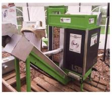
Modell eines neuen Durchlauftrockners für Holzhackschnitzel von Holzwert.
