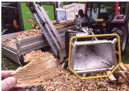
Der «Effiter 20.30» von Alvattec produziert «aufgefächerte» Holzstücke, die gut trocknen.
