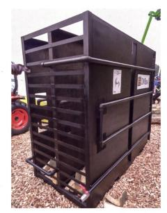
Die Trocknungsbox von Drywoodbox wird von Heizwasser durchströmt. Der Strombedarf für Ventilatoren entfällt.
