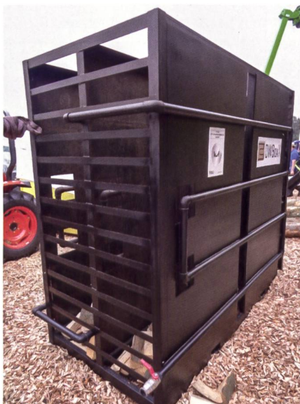
Die Trocknungsbox von Drywoodbox wird von Heizwasser durchströmt. Der Strombedarf für Ventilatoren entfällt.
