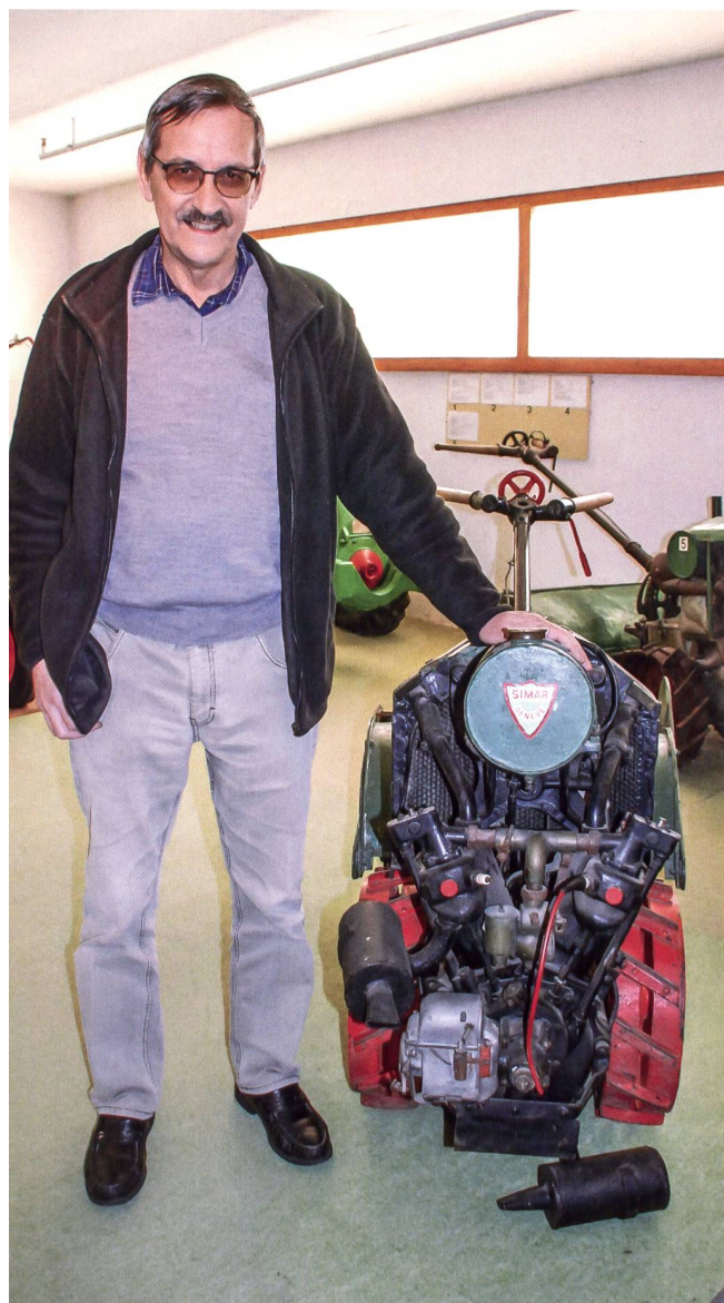
Pierre-Alain Humbert im Agrarmuseum Chiblins bei der Motorfräse von 1922 mit 2-Zylinder-V-Motor und Wasserkühlung von Motosacoche. Bilder: Dominik Senn
