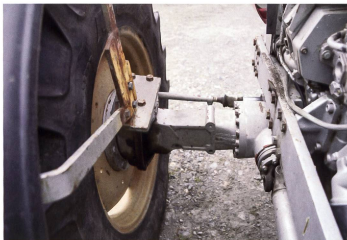
Das Selbstsperrdifferential Locomatic garantiert automatisch eine schlupffreie Kraftübertragung über beide Vorderräder.
