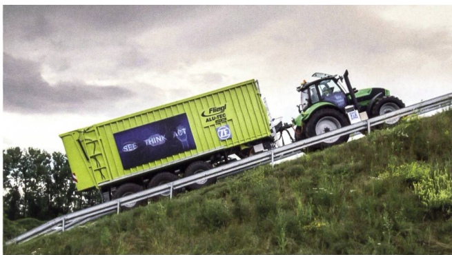
Mit dem Traktionsmanagement des «Innovation Tractor» sollen problemlos steile Berganfahrten bis 30% gelingen.
