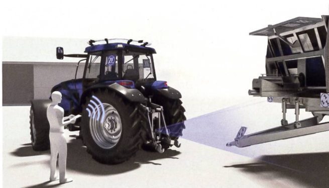
Der «Innovation Tractor» steuert die Arbeitsgeräte automatisch an, sodass sie sich bequem ankoppeln lassen.
