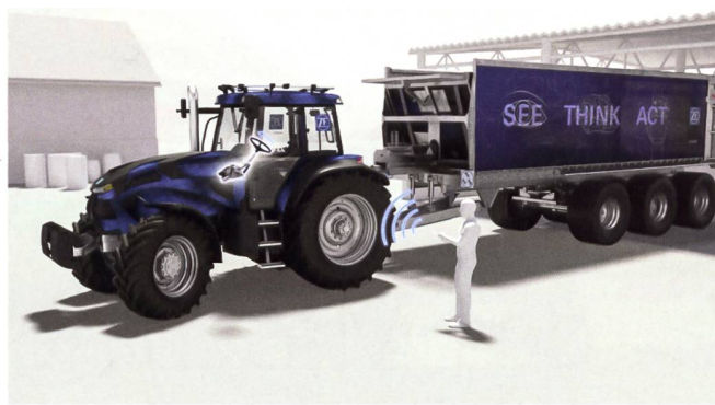
Der Traktor lässt sich mittels eines Tablets von ausserhalb der Fahrerkabine rangieren.
