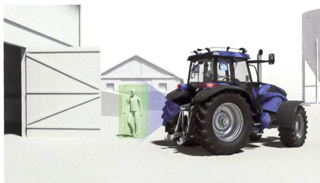
Dank «Pedestrian Detection» stoppt der «Innovation Tractor» seine automatische Rangierfahrt, wenn Menschen im Weg stehen.
