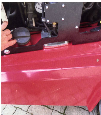
Links und rechts im hinteren Chassisteil sind der Diesel- und Öltank untergebracht.
