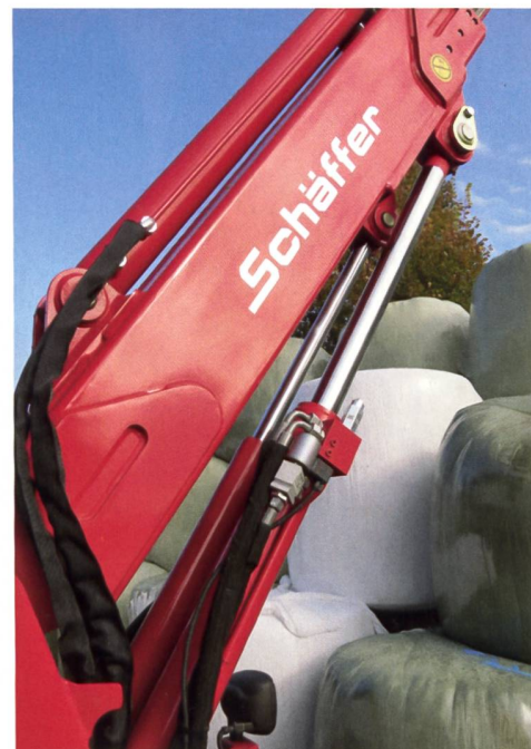
Die hydraulische Parallelführung passt den Winkel des Anbaugeräts über die Z-Kinematik der Ladeanlage immer an.
