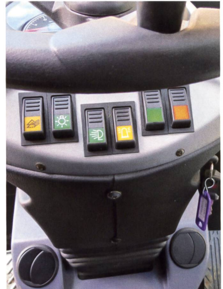
Zusätzliche Funktionstasten wie Schwingungstilgung für die Strassenfahrt oder Werkzeugverriegelung befinden sich unter dem Lenkrad.
