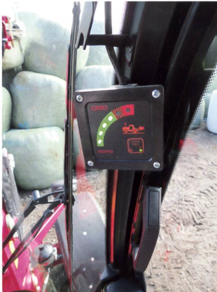
Eine gut sichtbare Lastanzeige zeigt dem Fahrer ein allfälliges Entlasten der Hinterachse an. Das System greift aber nicht aktiv ein.
