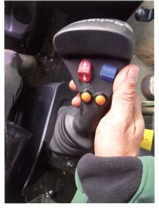
Alle Hydraulikfunktionen werden über den Multifunktionsjoystick auf der Seitenkonsole betätigt. Eine Armauflage erleichtert die Bedienung.
