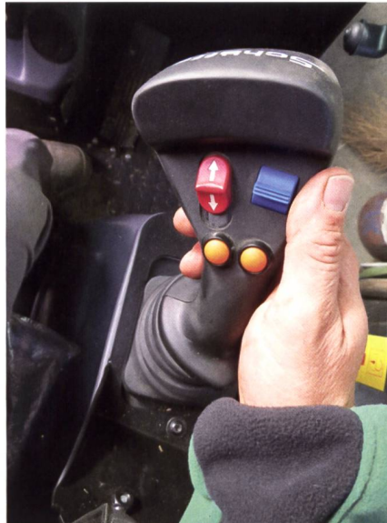
Alle Hydraulikfunktionen werden über den Multifunktionsjoystick auf der Seitenkonsole betätigt. Eine Armauflage erleichtert die Bedienung.
