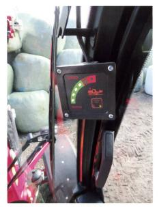
Eine gut sichtbare Lastanzeige zeigt dem Fahrer ein allfälliges Entlasten der Hinterachse an. Das Systeme greift aber nicht aktiv ein.
