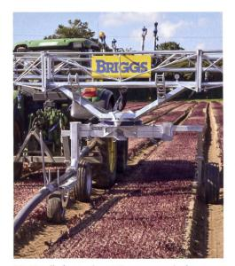
Die Handhabung eines Düsenwagens ist heute ausgereift. Im Bild: Auszug eines teilweise eingeklappten Düsenwagens mit Offset-Chassis. Bild: Briggs
