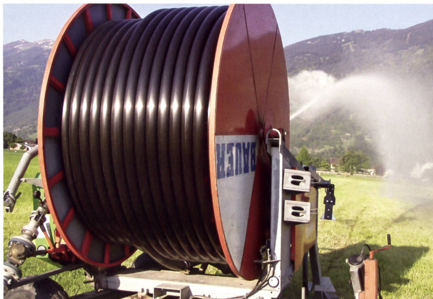
Die Entwicklung trommelbarer PE-Kunststoffrohre löste ab 1970 einen grossen Entwicklungsschritt in der Beregnungstechnik aus. Bild: R. Hunger
