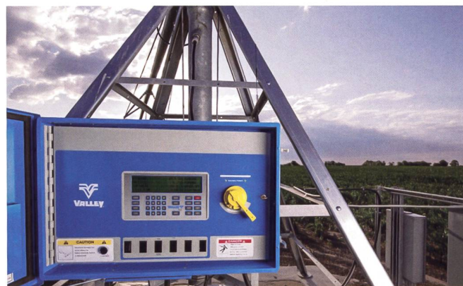
Der Zentralturm einer Kreis- oder Linearberegnungsanlage ist das «Hirn» der Anlage. Hier wird das Wasser eingespeist, und von diesem Punkt aus wird die Anlage gesteuert. Bild: Valley
