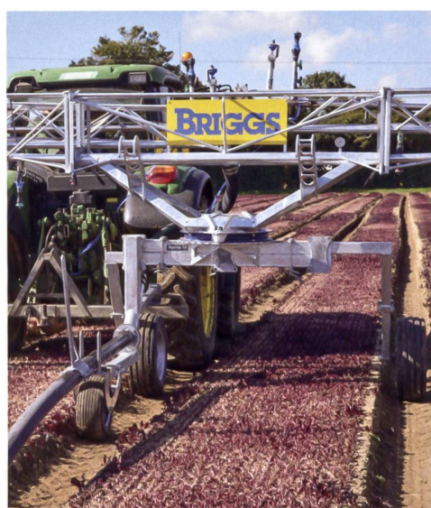
Die Handhabung eines Düsenwagens ist heute ausgereift. Im Bild: Auszug eines teilweise eingeklappten Düsenwagens mit Offset-Chassis. Bild: Briggs
