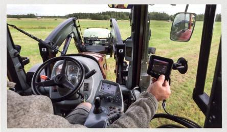
Alö bringt mit den Frontladern der «Q»-Serie eine neue Generation mit zahlreichen Verbesserungen und neuen Leistungsmerkmalen auf den Markt. Eine Komponente des neuen Systems ist der «Q-Companion», ein Supportsystem für die Handhabung von Lasten, das sich aus einem integrierten Wiegesystem, einer Positionierungshilfe und adaptiven Wartungshinweisen zusammensetzt. Das innovative System soll mit moderner Sensortechnologie die Arbeit mit den Ladern er-
