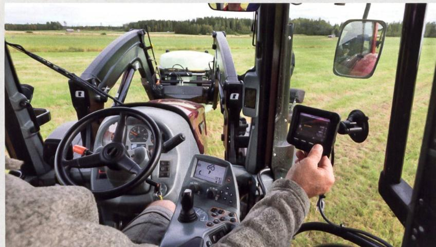
Älö bringt mit den Frontladern der «Q»-Serie eine neue Generation mit zahlreichen Verbesserungen und neuen Leistungsmerkmalen auf den Markt. Eine Komponente des neuen Systems ist der «Q-Companion», ein Supportsystem für die Handhabung von Lasten, das sich aus einem integrierten Wiegesystem, einer Positionierungshilfe und adaptiven Wartungshinweisen zusammensetzt. Das innovative System soll mit moderner Sensortechnologie die Arbeit mit den Ladern erle-
