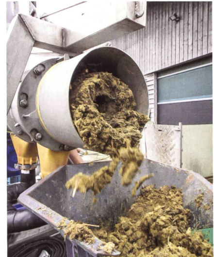
Rohgülle kann mit einer Siebpressschnecke in Dünngülle und Feststoffe separiert werden. Siebpressschnecken haben einen geringen Energiebedarf und können als mobile Anlagen überbetrieblich eingesetzt werden. Bilder: «Lever»-Schlussbericht
