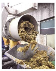
Rohgülle kann mit einer Siebpressschnecke in Dünngülle und Feststoffe separiert werden. Siebpressschnecken haben einen geringen Energiebedarf und können als mobile Anlagen überbetrieblich eingesetzt werden. Bilder: «Lever»-Schlussbericht
