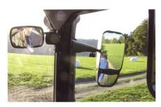
Die zweiteiligen Rückspiegel mit Weitwinkelsicht sind optimal gestaltet und ermöglichen eine lückenlose Sicht nach hinten.
