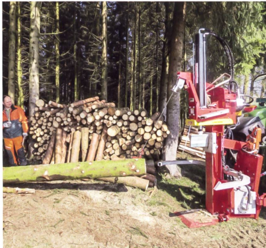
Mit der integrierten Seilwinde lassen sich Holzstämme bis 20m Entfernung zum Spalter heranziehen.
