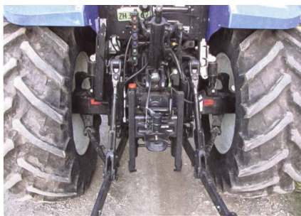
Die Hydraulikkupplungen sind neu in einer Reihe übereinander angeordnet. Die Federelemente der Kabinenfederung wurden nach aussen versetzt.
