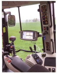
Sämtliche Bedienelemente sind auf der rechten Kabinenseite und am «B»-Holm ergonomisch sinnvoll angeordnet.
