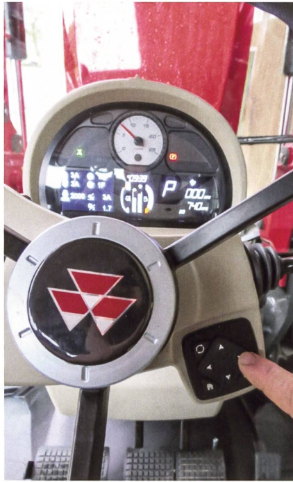
Bedient wird das «SIS»-Terminal über die Tasten neben dem Lenkrad.
