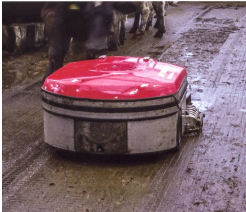
Nun auch für plane, geschlossene Stallböden verfügbar: Der Lely «Discovery 120 Collector» schiebt den Mist nicht vor sich hin, sondern sammelt ihn auf. Bilder: R. Engeler
