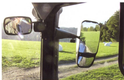
Die zweiteiligen Rückspiegel mit Weitwinkelsicht sind optimal gestaltet und ermöglichen eine lückenlose Sicht nach hinten.
