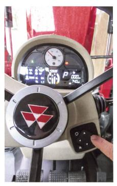
Bedient wird das «SIS»-Terminal über die Tasten neben dem Lenkrad.
