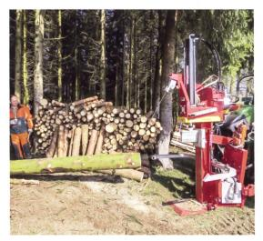
Mit der integrierten Seilwinde lassen sich Holzstämme bis 20 m Entfernung zum Spalter heranziehen.
