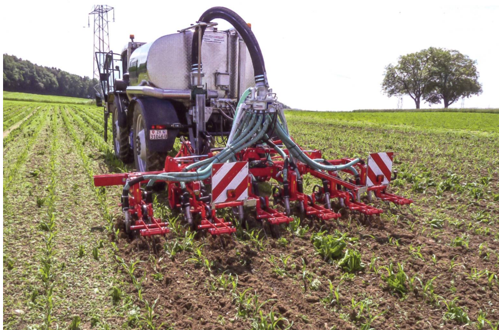
Selbstfahrer für das Gülleeinbringen im Mais: «Hydrotrac» mit Tankaufbau, Verteilkopf und Schlauchleitungen zum 6-reihigen Hackgerät. Bilder R. Engeler/P. Briner
