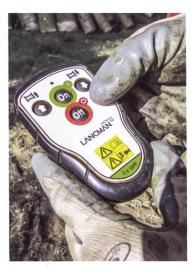
Die Seilwinde wird mit diesem kleinen Sender funkgesteuert.
