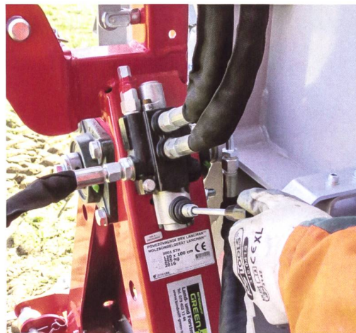
Mit dem Steuerventil auf der Rückseite des Bündelgeräts fährt man den Spannzylinder aus, hängt ein Kettenglied passend ein und zieht den Bund zusammen.
