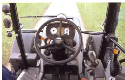
Neu werden bei der Lenkradverstellung auch die Anzeigen und Bedienelemente in Höhe und Neigung mitverstellt.
