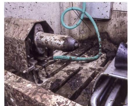
An der Docking-Station wird der Roboter aufgeladen, kann über diese Kupplung Wasser aufnehmen und den Tankinhalt entleeren.
