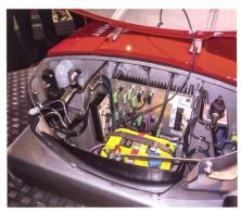
Blick in den Innenraum des neuen Roboters: links die Technik für die Vakuumpumpe, in der Mitte die elektronischen Steuerungskomponenten und rechts die Module für die Wasserversorgung.
