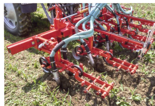
Das Hackgerät «Chopstar» von Einböck mit den zusätzlich angebrachten Chromstahlrohren für das Einbringen der Gülle.
