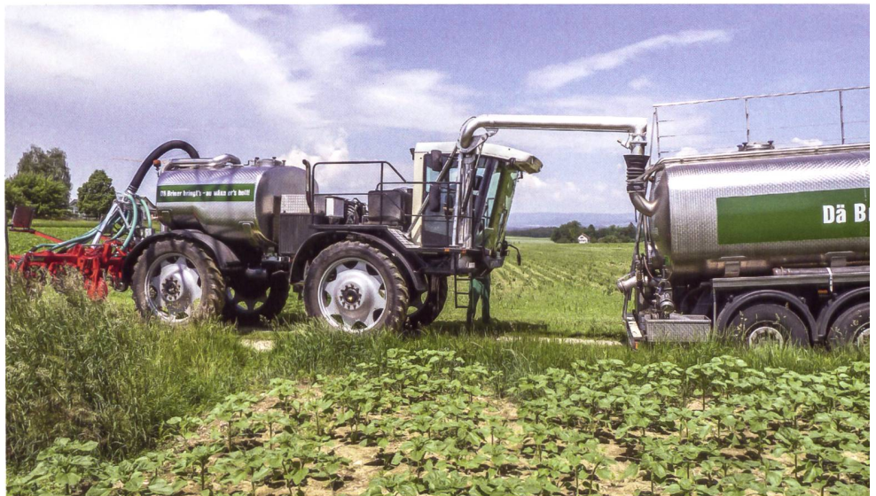
Der Überladevorgang am Feldrand dauert für die 6 m 3 rund drei Minuten.
