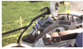
Die wichtigsten Bedienelemente sind auf der Seite im «Command Arc» zusammengefasst. Am Joystick auf der Armlehne kann der Fahrer neu auch die Schaltung bedienen.
