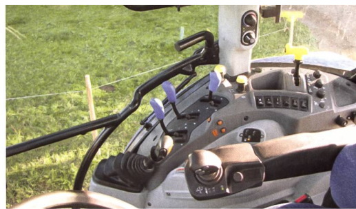
Die wichtigsten Bedienelemente sind auf der Seite im «Command Arc» zusammengefasst. Am Joystick auf der Armlehne kann der Fahrer neu auch die Schaltung bedienen.
