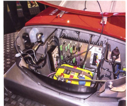
Blick in den Innenraum des neuen Roboters: links die Technik für die Vakuumpumpe, in der Mitte die elektronischen Steuerungskomponenten und rechts die Module für die Wasserversorgung.
