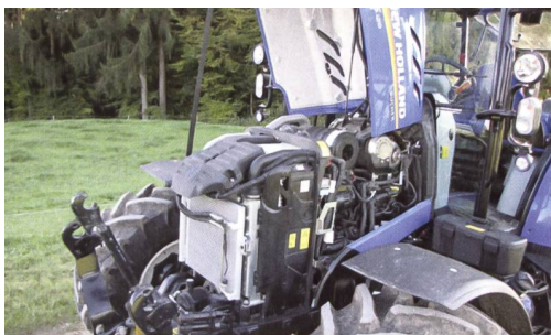
Die Motorhaube kann einfach und weit geöffnet werden. Zur Reinigung von Wasser- und Ladeluftkühlung können zwei seitliche Leitbleche einfach abgeschraubt werden.
