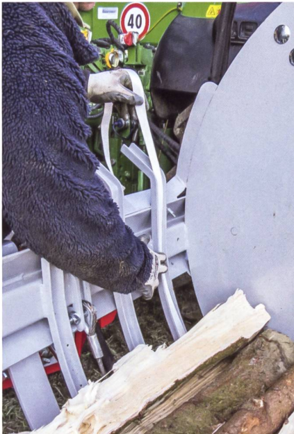
Das Polyesterband muss auf einer Seite vor dem Befüllen des Bündeltrogs in das U-Profil eingelegt werden.
