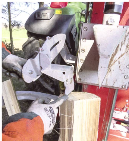
Der Spalter ist mit einer verstellbaren Fixierkralle ausgerüstet, um das zu bearbeitende Holz sicher unter dem Spaltkeil positionieren zu können.
