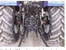
Die Hydraulikkupplungen sind neu in einer Reihe übereinander angeordnet. Die Federelemente der Kabinenfederung wurden nach aussen versetzt.
