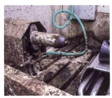
An der Docking-Station wird der Roboter aufgeladen, kann über diese Kupplung Wasser aufnehmen und den Tankinhalt entleeren.
