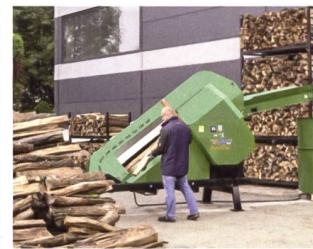
scheite der ergonomischen Holzablage, auf der auch ganze Holzbündel abgelegt werden können. Der Automat ist mit einer Holzrutsche mit 100 cm Auswurfhöhe oder mit Förderbändern bis 3,0 m Auswurfhöhe lieferbar.
