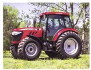
Von Tym wird das neue Traktorenmodell «T1054 SP» vorgestellt, das von einem Doosan-Motor mit 105PS angetrieben wird. Das 32/32-Gang-Getriebe verfügt über vier Gruppen, eine Lastschaltstufe und eine Powershuttle-Wendeschaltung. Der Traktor ist mit drei Steuergeräten am Heck, einer EHR sowie Zapf-
