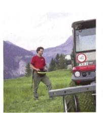
Der ebenfalls neue «Terratrac» mit der Option «Autonomes Fahren» ist ein mit GPS selbstständig, fahrerlos arbeitender Zweiachs-Geräteträger. Die Route wird innerhalb des vordefinierten Arbeitsfeldes automatisch geplant. Einmal programmiert, mäht die Maschine selbstständig, während der Fahrer parallel andere Aufgaben vor Ort erledigt. Die Arbeitsrouten sind zentimetergenau repetierbar. Weiter stellt Aebi zwei neue «Terratrac»-Modelle vor (siehe Seite 12).
