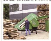
scheite der ergonomischen Holzablage, auf der auch ganze Holzbündel abgelegt werden können. Der Automat ist mit einer Holzrutsche mit 100 cm Auswurfhöhe oder mit Förderbändern bis 3,0 m Auswurfhöhe lieferbar.
