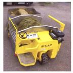
neu eine ganze Maisrundballe auf einmal aufnehmen. Angetrieben wird das wendige Dreiradfahrzeug von einem 18-PS-Benzinmotor. Der Fahrantrieb wie auch der Antrieb der Austragungselemente erfolgen hydraulisch.
