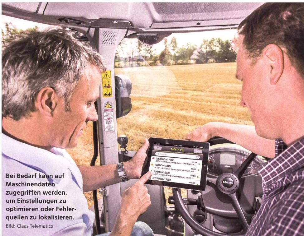
Bei Bedarf kann auf Maschinendaten zugegriffen werden, um Einstellungen zu optimieren oder Fehlerquellen zu lokalisieren.
