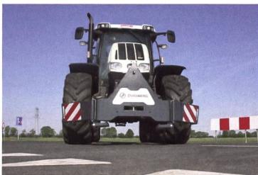
Um Fahrzeuge und Maschinen sicherer zu gestalten und eine entsprechende Nachfrage zu erfüllen, bringt Zuidberg Frontline Systems einen bezahlbaren Auffahrtschutz für Traktoren auf den Markt. Die Sichtbarkeit und Erkennbarkeit des Traktors wird verbessert und der Schaden bei einem Unfall so weit wie möglich begrenzt. Mit dem neuen Frontkrafthebekonzept garantiert
