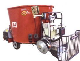
in der Schweiz gefertigt. Der Fahrkopf «Classic» ist erhältlich mit Seitenschieber und Förderband hinten. Die kostengünstigste Lösung für die Fütterung, unabhängig vom Schlepper!
