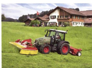
Leistungen von 80 bis 120 PS in drei verschiedenen Grundvarianten gibt: Mit 4-Gang-Getriebe, mit oder ohne Lastschaltstufen oder mit einem 5-Gang-Getriebe, «Ecospeed», 3 Lastschaltstufen und 5-fach einstellbarem Wendegetriebe, stets kombiniert mit 4-Rad-Scheibenbremsen im Ölbad, 4-fach-Heckzapfwelle, Komfortcabine oder 3 Zusatzsteuergeräten und automatischer Anhängevorrichtung. Abgerundet wird die Produktschau mit Schmalspur- und Grünlandtraktoren im Segment von 60 bis 100 PS.
