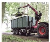
Der neue «THL 25 L» mit Kranaufbau ist die grösste Haken-Kran-Kombination. die Krampe bis dato gebaut hat. Krampe-Tridem-Hakenliftanhänger werden serienmässig mit zwei gelenkten Achsen und einem luftgefederten Fahrwerk ausgerüstet. Damit sind eine sichere Lenkung und ein hoher Fahrkomfort auch auf unwegsamem Terrain garantiert. Das Rangieren mit dem Fahrzeug ist trotz seiner Abmessungen kein Prob-
