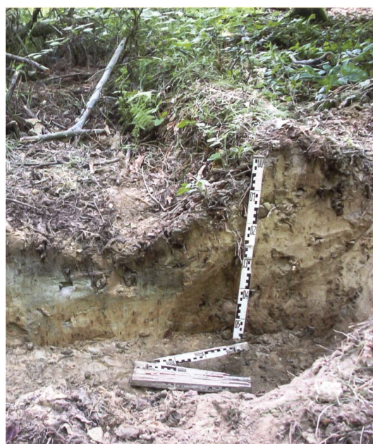
Verdichtetes Bodenprofil mit den typischen seitlichen Aufwölbungen und staunässebedingter Verfärbung unter einer früheren Fahrspur. Bild: WSL
