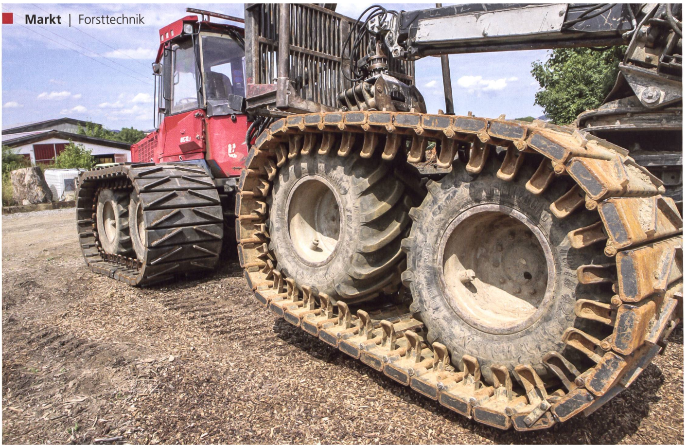
Das rückenversteifte «Marquardt»-Band besteht aus 36 Stegen, mit einem Rechteckprofil von 200×80 mm, die Wandstärke beträgt 8 mm.
