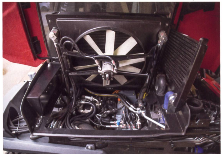
Blick in den Motorraum mit dem Lüfter, der optional als Umkehrlüfter geordert werden kann.
