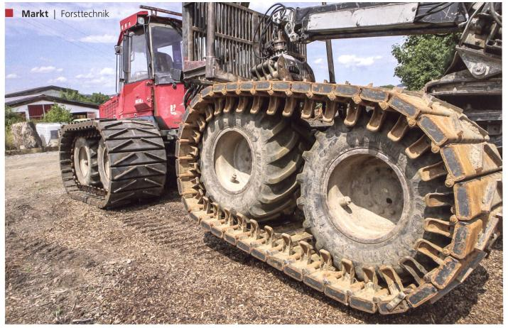
Das rückenversteifte «Marquardt»-Band besteht aus 36 Stegen, mit einem Rechteckprofil von 200 x 80 mm, die Wandstärke beträgt 8 mm. Bild: Bombosch, HAWK Göttingen
