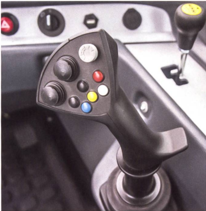
Der neue Fahrhebel erlaubt ein Ansteuern der wichtigsten Funktionen mit nur einer Hand.
