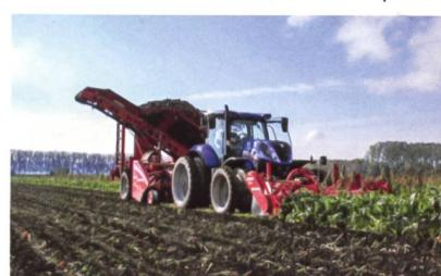
gen Verfahren gemeinsam mit dem «Rootster 604» eingesetzt wurde. Der «FT 300» ist mit einer Blattablage ausgestattet, die Verstopfungen im Bereich des Nachköpfers vermeidet. Der ebenfalls 6-reihige und gezogene Rübenernter «Rootster» mit 4-Tonnen-Überladebunker kann von einem Traktor aus (mindestens 185PS Leistung) über ein Bedienterminal gesteuert werden und sowohl im 1-phasigen Verfahren als auch im 2-phasigen Verfahren mit dem «BM 300» eingesetzt werden.
