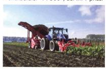
gen Verfahren gemeinsam mit dem «Rootster 604» eingesetzt wurde. Der «FT 300» ist mit einer Blattablage ausgestattet, die Verstopfungen im Bereich des Nachköpfers vermeidet. Der ebenfalls 6-reihige und gezogene Rübenroder «Rootster» mit 4-Tonnen-Überladebunker kann von einem Traktor aus (mindestens 185 PS Leistung) über ein Bedienterminal gesteuert werden und sowohl im 1-phasigen Verfahren als auch im 2-phasigen Verfahren mit dem «BM 300» eingesetzt werden.
