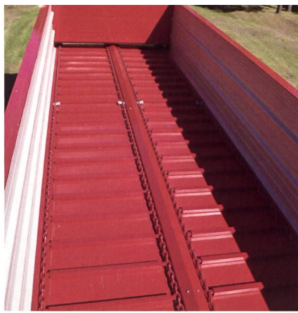
Der zweireihige Kombi-Sattelkratzboden schafft eine Entleerungszeit von rund zweieinhalb Minuten.
