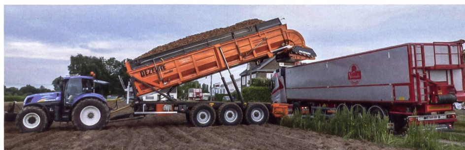
Der «Turbo-Cleaner» von Dezeure im Einsatz. Mit diesem Wagen werden die Kartoffeln vom Roder übernommen, auf einen LKW umgeladen und gleichzeitig gereinigt. Bild: deloonwerker.be
