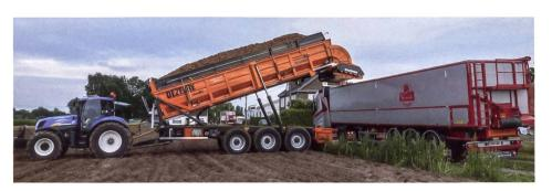
Der «Turbo-Cleaner» von Dezeure im Einsatz. Mit diesem Wagen werden die Kartoffeln vom Roder übernommen, auf einen LKW umgeladen und gleichzeitig gereinigt. Bild: deloonwerker.be
