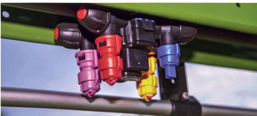
Silber gab es für Amazone und die elektrische Einzeldüsenschaltung «AmaSelect», mit der sich bis zu 5 % Pflanzenschutzmittel einsparen lassen sollen. Bild: Amazone
