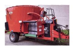
Gleich drei neue Baureihen präsentiert Kuhn. Die Ein-Schnecken-Vertikalmischwagen zeichnen sich durch konstruktive Merkmale aus, die sich bereits bei den Zwei-Schnecken-Vertikalmischern bewährt haben. Dazu zählen der niedrige Leistungsbedarf, die hohe Mischgenauigkeit und eine platzsparende Bauweise. Beispielsweise liegt die Gesamthöhe der Modelle mit 14 m³ unter drei Meter. www.kuhn.com
