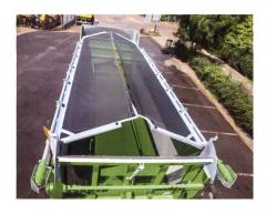
Joskin bietet sowohl für seine «Silo-Space»-Anhänger als auch für die Multifunktionsanhänger «Drakkar» ein neues Abdecksystem an. Mit dem «Duo-Cover» steht ein einfaches System zur Verfügung, das sich in zwei Netzgittern auch angewinkelt über das Ladegut legt. Das Gitter dreht sich mittels elektrohydraulischer Steuerung um 270° bzw. kann auch vom Traktor aus gesteuert werden. Die Gitter legen sich druckbelastet auf das Ladegut. www.joskin.com
