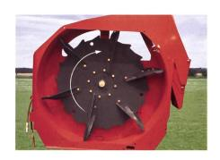
triebe und der seitliche Schwanenhals-Auswurf. Je nach Grösse (2 bis 6 m³) baut Vicon angebaute und gezogene Maschinen. Dank dem speziellen «DFCS»-System verhindert ein Kamm Blockaden des Schwungrades, wenn dieses angefahren wird. Der «Shredex»-Ballenhäcksler kann zum Einstreuen oder auch zum Füttern eingesetzt werden.
