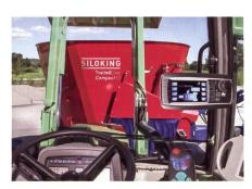
Eine Neuentwicklung, die Siloking zur EuroTier vorstellt, ist das funkgesteuerte Wiege-, Steuerungs- und Dokumentationssystem «Siloking Data». Im Funkterminal mit hochauflösendem Farb-Display werden die gespeicherten, Rezepte abgearbeitet, geändert und neue Be- und Entladeprogramme angelegt. Das Terminal ist stets im Sichtfeld des Fahrers platziert. Der Fahrer kann den Wagen von beiden Seiten aus befüllen. Optional ist für die Beladung der Einsatz eines Smartphones oder Tablets möglich.
