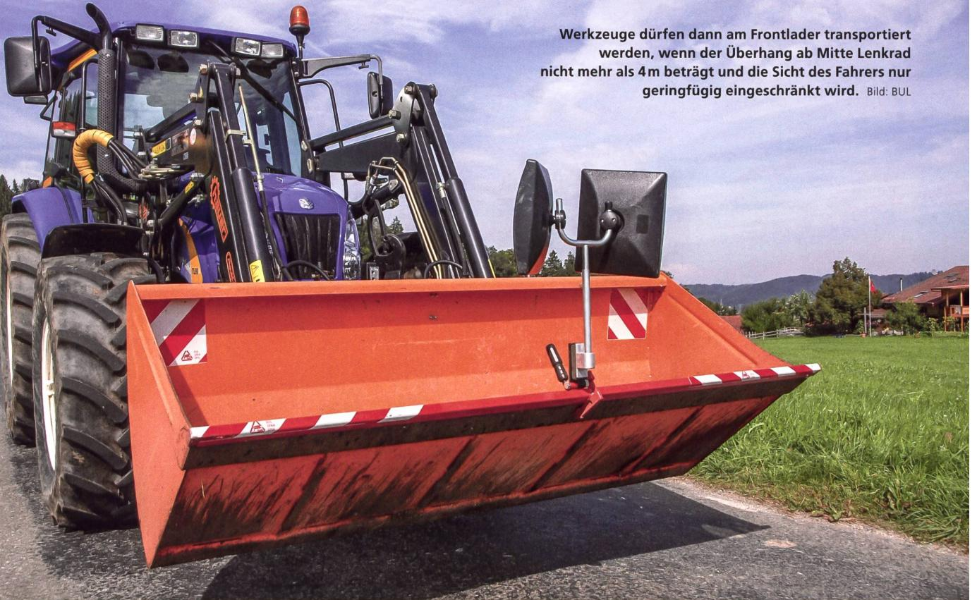
**Werkzeuge dürfen dann am Frontlader transportiert werden, wenn der Überhang ab Mitte Lenkrad nicht mehr als 4m beträgt und die Sicht des Fahrers nur geringfügig eingeschränkt wird.** Bild: BUL
