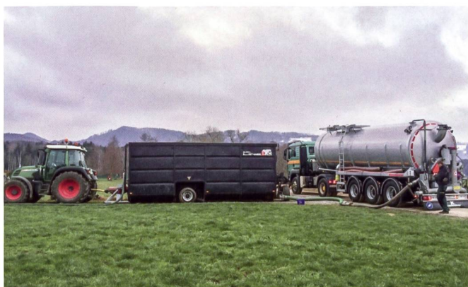
Die Versorgungsgeräte, bestehend aus Sattelschlepper, Zwischenbunker, Traktor und Förderpumpe (Variante «Verschlauchung ab Feldrand»).
