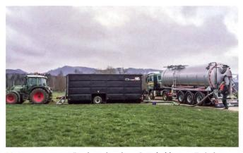
Die Versorgungsgeräte, bestehend aus Sattelschlepper, Zwischenbunker, Traktor und Förderpumpe (Variante «Verschlauchung ab Feldrand»).
