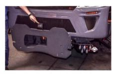
Unmittelbar beim Anbau eines Gerätes wird dieses durch das «TracLink»-System erfasst und erkannt.
