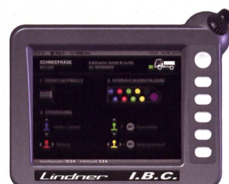
Auf dem «IBC»-Terminal werden die richtigen Hydraulikcupplungen, Steuergeräte und Zapfwellendrehzahlen angezeigt.
