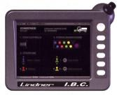
Auf dem «IBC»-Terminal werden die richtigen Hydraulikkupplungen, Steuergeräte und Zapfwellendrehzahlen angezeigt.
