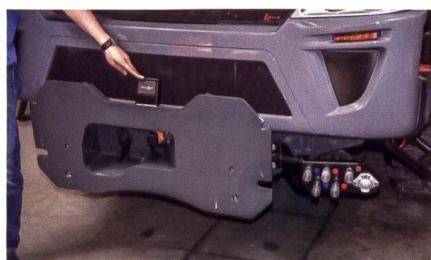
Unmittelbar beim Anbau eines Gerätes wird dieses durch das «TracLink»-System erfasst und erkannt.
