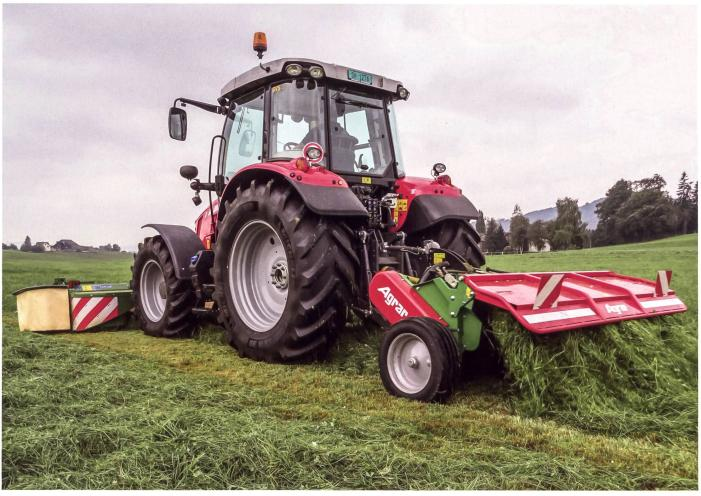
Der Aufbereiter Agrar «IC 20» wurde in Kombination mit einem Frontmähwerk Krone «EasyCut 360» und mit einem Traktor «MF 5613» eingesetzt. Bilder: M. Abderhalden und R. Engeler.
