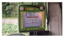
Isobus erlaubt es, den Streuer mit dem Terminal des Traktors, mit einem anderen Isobuskompatiblen Terminal oder über das Amazone-eigene Terminal zu bedienen.
