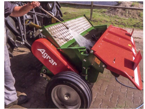
Die Haube samt Konditionierungsblech kann für Reinigung und Unterhalt werkzeuglos nach vorne geklappt werden.
