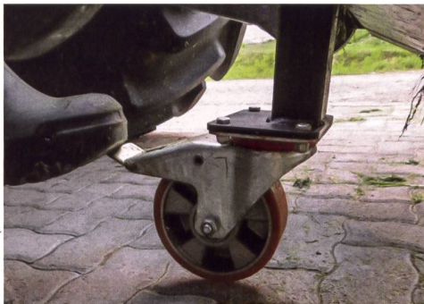
Um die Maschine nach dem Gebrauch abzustellen, ist ein klappbares, mit Bremse versehenes Stützrad montiert.
