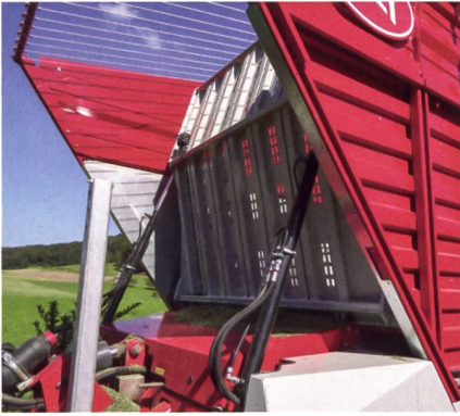
Die multifunktionale Stirnwand kann um 80° schwenken, schafft 6 m³ zusätzliche Ladekapazität und übernimmt weitere Funktionen beim Laden und Entladen.
