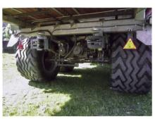
Die optionale Nachlauf-Lenkachse wird über die Isobus-Steuerung und die Load-Sensing-Hydraulik je nach Fahrgeschwindigkeit und bei Rückwärtsfahrt automatisch gesperrt.
