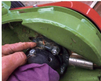
Dank der raffinierten Gestaltung der Riemenspannung sieht man von aussen, ob die Spannung stimmt.
