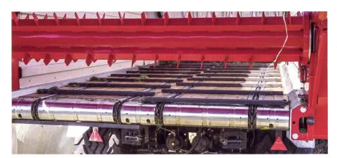
Der zweigeteilte Kratzboden wird über vier Ketten angetrieben, serienmässig mit einem 12-m/min-Getriebe, optional gibt es Zweistufen-Getriebe (12/24 m/min).
