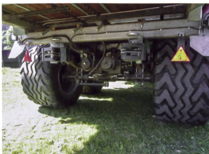
Die optionale Nachlauf-Lenkachse wird über die Isobus-Steuerung und die Load-Sensing-Hydraulik je nach Fahrgeschwindigkeit und bei Rückwärtsfahrt automatisch gesperrt.
