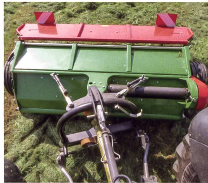
Der Nachlauf-Pendelbock kann seitlich weit schwenken. Zwei Dämpfer sorgen für ein sanftes Arretieren beim Anheben.
