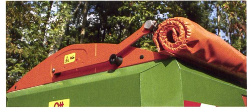
Praktisch: automatisch aufrollende Plane und Abstellsystem mit per Fuss bedienbaren Stützrollen.
