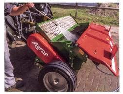
Die Haube samt Konditionierungsblech kann für Reinigung und Unterhalt werkzeuglos nach vorne geklappt werden.
