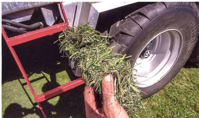
Scharfer Schnitt: Die 31 Messer zwischen den breiten Stegen des Rotors sorgen für eine theoretische Schnittlänge von 45 mm.
