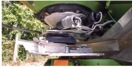
Der Aufgabepunkt des Düngers und die Trichteröffnung sind elektrisch verstellbar.
