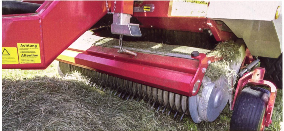
Der Pick-up ist 1,80 m breit, weist fünf ungesteuerte Zinkenreihen auf, wird mechanisch über Ketten angetrieben und ist per Freilaufkupplung gegen Überlast gesichert.
