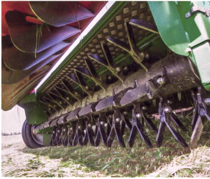
126 versetzt angeordnete und rund 15 cm lange V-Zinken aus Stahl können frei pendeln und Fremdkörpern ausweichen.
