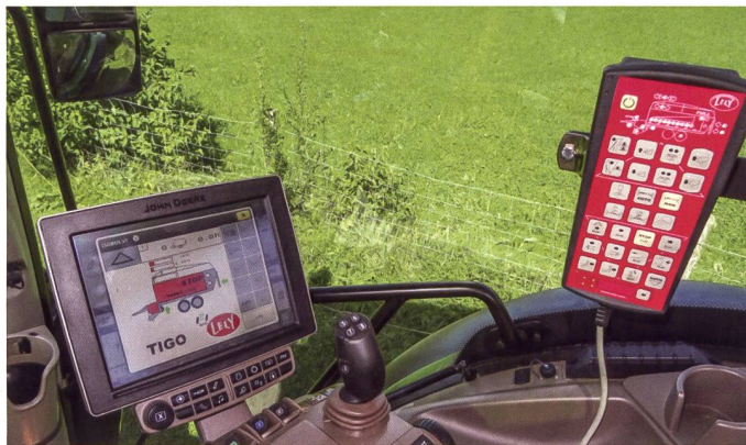
Die Bedienung erfolgt wahlweise über das Traktor-Terminal, über das von Lely mitgelieferte Bediengerät mit Folientastatur oder aber über beide.
