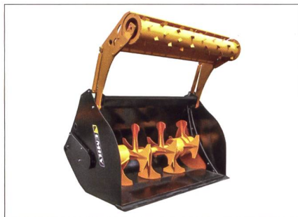
Emily bietet Schaufeln mit Entnahmefräse und Paddelmischer in zahlreichen Versionen und in allen Grössen an.
