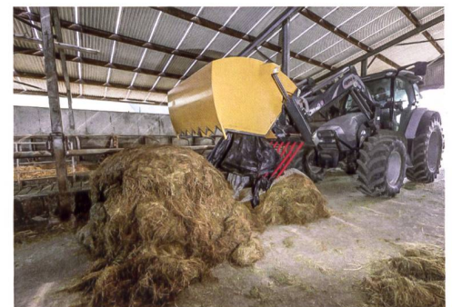
Die Schneidzange «I75 Multi Shear» von Tanco kann auch Rundballen verarbeiten und ist dazu mit Folienrückhalter ausgerüstet.
