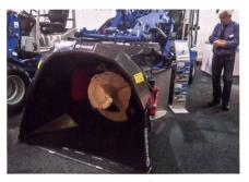
Quappen bietet Mischbehälter mit messerbestückten vertikalen Mischschnecken in verschiedenen Grössen an.
