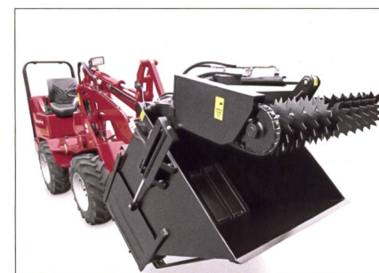
Einige Hofladerhersteller bieten Behälter mit Entnahmefräse und Austragungsfunktion bereits mit Breiten unter einem Meter an.
