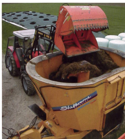
Dieses Werkzeug vereint die Vorteile von der Dichtigkeit einer Schaufel und der Schneidzange.
