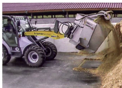
Dieses Gerät von Sieplo macht den Lader mit einer Entnahmefräse und vertikalen Mischschnecken zum Mischwagen.
