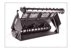
Die Entnahme- und Verteilschaufel «BD 1400» von MX ist mit einer Austragungsschnecke und Mischsternen ausgerüstet.
