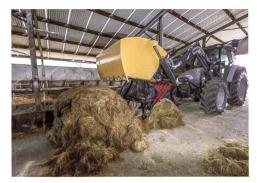
Die Schneidzange «I75 Multi Shear» von Tanco kann auch Rundballen verarbeiten und ist dazu mit Folienrückhalter ausgerüstet.
