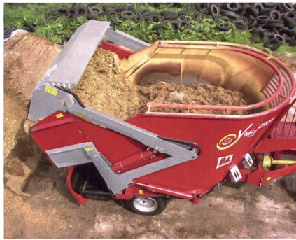
Vertikale Selbstbefüller gibt es schon einige Jahre, sie sind aber immer noch eine Ausnahme.
