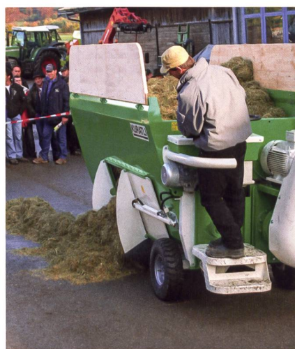
Kleine und mittlere Betriebe mit einfachen und engen Durchfahrten setzen vielfach auf kleine Selbstfahrer mit elektrischem (oder motorischem) Antrieb. Bild: C. Jenni
