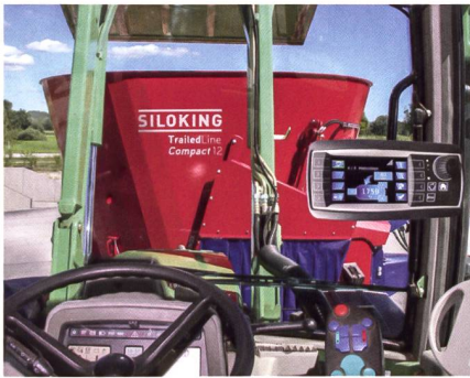
Fremdbefüller müssen mit einem Hebefahrzeug beladen werden, dabei ist der direkte Blick auf die Wiegedaten ein grosser Vorteil.
