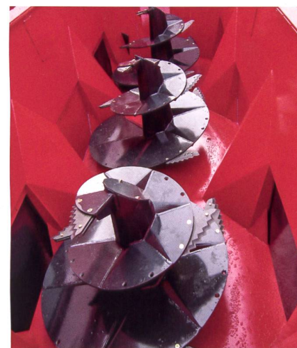
Vertikale Futtermischwagen sind mit bis drei vertikal arbeitenden Mischschnecken ausgerüstet.
