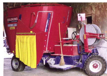
Elektrische Antriebskonzepte nehmen zu. Sie sind leise und unabhängig von einem Traktor. Bild: R. Hunger
