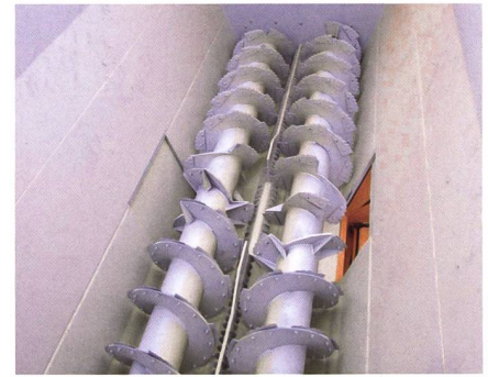
Horizontale Futtermischwagen gibt es mit ein bis vier Mischschnecken. «Horizontal» bezieht sich auf die Lage der Schnecken.
