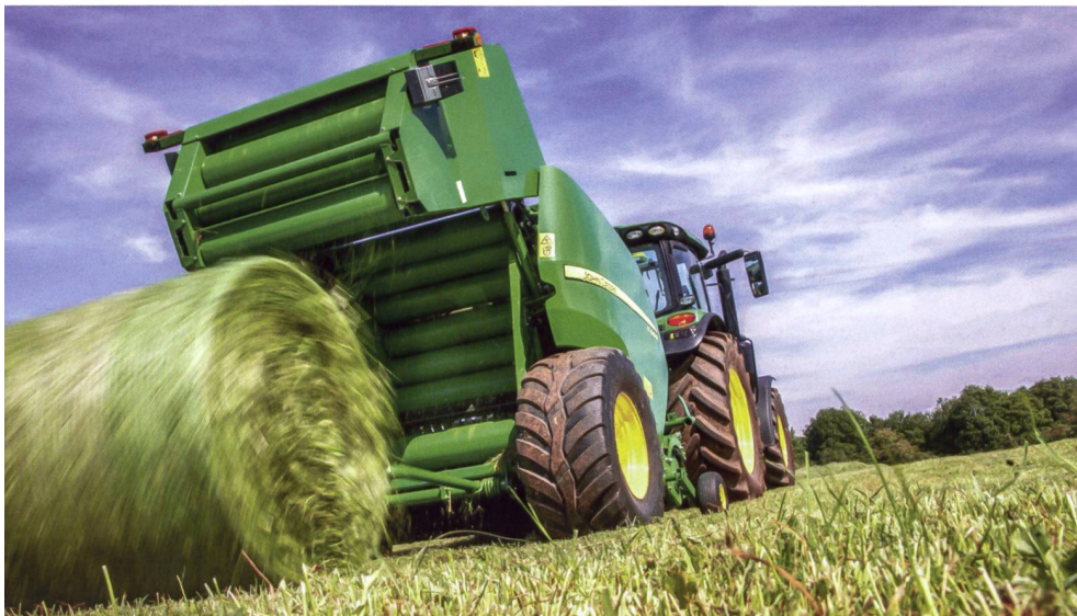
Die neuen Premium-Festkammerpressen werden mit einer zusätzlichen 18. Walze ausgestattet. Bilder: zvg
