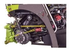
Über die obere Gelenkwelle erfolgt die stufenlose, hydrostatische Schnittlängeneinstellung, die untere Gelenkwelle ist für den variablen Vorsatzantrieb verantwortlich.
