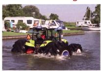
Mitas' grossvolumige Reifen ermöglichten es einem über 4t schweren Claas «Axos 320», über das Wasser zu fahren. Ohne die Flotation-Reifen wäre dieser
