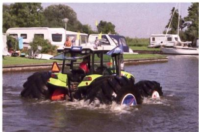
Mitas' grossvolumige Reifen ermöglichen es einem über 4t schweren Claas «Axos 320», über das Wasser zu fahren. Ohne die Flotation-Reifen wäre dieser
