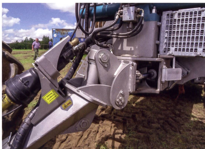
Für die Rückeanhänger hat Pfanzelt ein Deichseltilt-Federungssystem entwickelt. Es kann den Anhänger im Hang waagrecht stellen.
