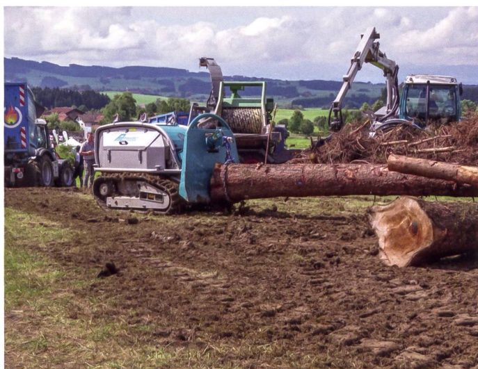
Die Fällraupe «Moritz» ist als hangtaugliche und bodenschonende Alternative zum Forstraktor mit angebaute Seilwinde gedacht.
