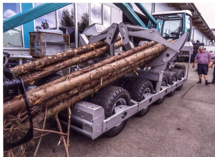
Fand Beachtung und warf Fragen auf: der Prototyp eines Rückewagens mit 22 breit bereiften Rädern für extrem feuchte Gebiete.
