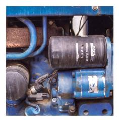
Das Nebenanschlussventil mit geschlossener Mittelstellung einschliesslich Hydraulikzahnradpumpe erlaubte beim Ford «6610» den Anschluss dieser Zusatzpumpe, welche die gesamte Förderleistung von standardmässig 351/min verdoppelt.
