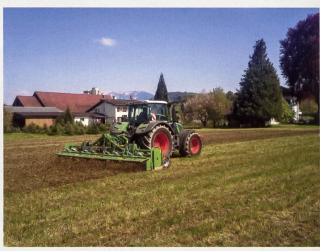
wird dabei fein gekrümelt, die vorhandene Grünmasse gemulcht, sodass sich ein weiterer Bearbeitungsvorgang vor der Saat erübrigt. Die Maschine kann aber auch für das reine Mulchen einer Gründüngung verwendet werden. Für diesen Zweck kann der Rotor mit den C-
