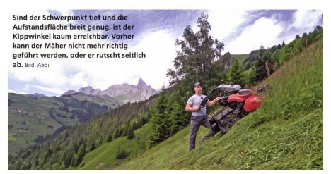
vention ab einer Längsneigung von +/-25° und einer Querneigung von +/-15° erfolgt. Das «AKS» besteht aus einem Drehraten- und einem Beschleunigungssensor sowie einem Mikroprozessor und einer komplexen Steuerungssoftware. Das hochpräzise Anti-Kipp-System reagiert in einer Ansprechzeit von 50 Millisekunden, und dies ab Neigungsänderungen von +/-1°. Das Überwachungsmodul ist KWF-geprüft und für gut befunden
