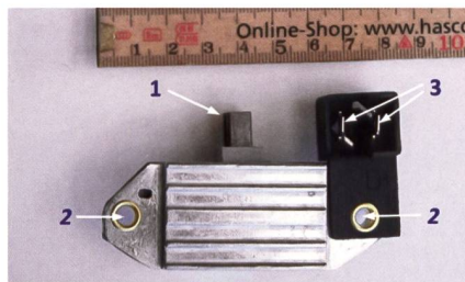
Bei neueren Alternatoren sind Spannungsregler und Kohlebürstenhalter in einem Bauteil integriert und lassen sich einfach auswechseln. 1 = Kohlebürsten, 2 = Löcher zur Befestigung des Bauteils, 3 = Anschlüsse für die Flachstecker.
