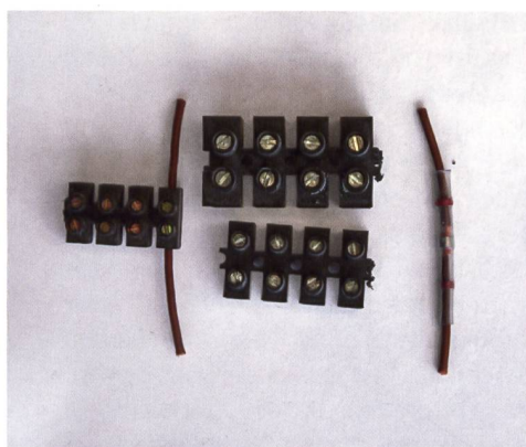
Lüsterklemmen, Flachstecker oder Lötverbinder mit integriertem Lot sind dauerhafte Lösungen, besonders wenn sie zusätzlich noch mit Isolierband oder einem Schrumpfschlauch geschützt werden.
