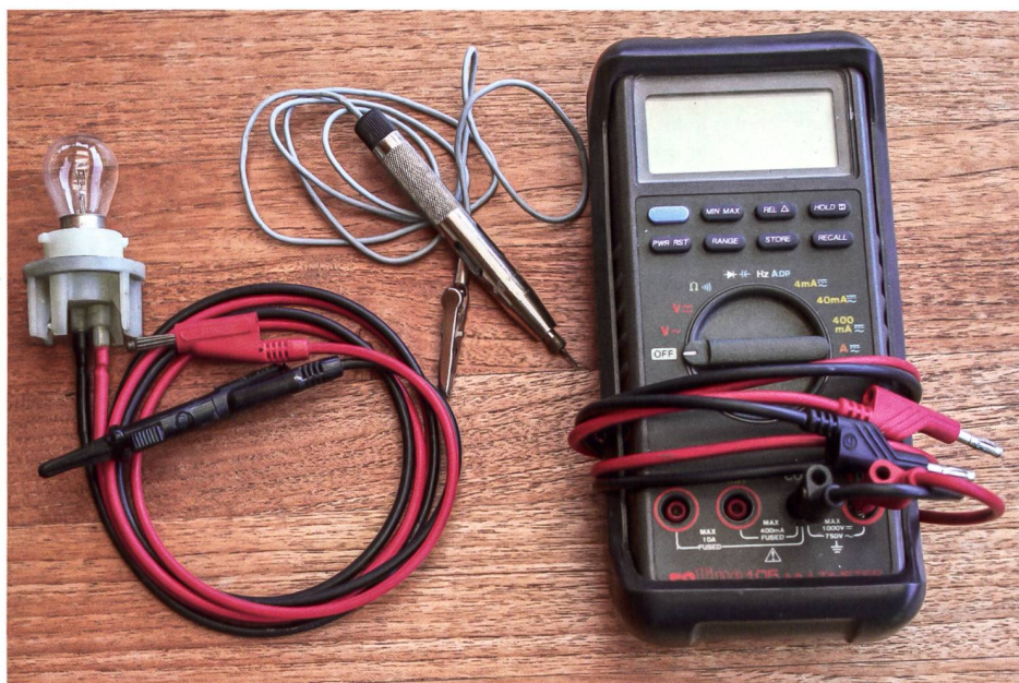
Mit einem Multimeter und Prüflampen, lassen sich – wenn gewusst, wie – die meisten Störungen an der Bordelektrik lokalisieren.
