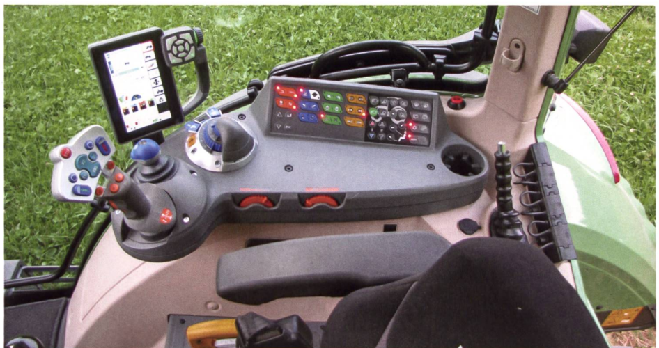
Die nach Farben logisch geordneten Bedienelemente sind alle in die Seitenkonsole integriert. Der Bildschirm ist in dieser Version eher etwas klein.
