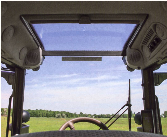
Das Panoramadach erlaubt freie Sicht auf den angehobenen Frontlader.
