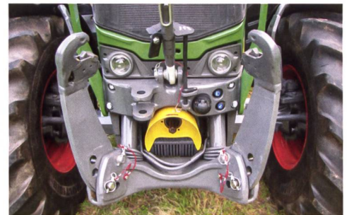
Das Fronthubwerk ist harmonisch in den taillierten Halbrahmen integriert.
