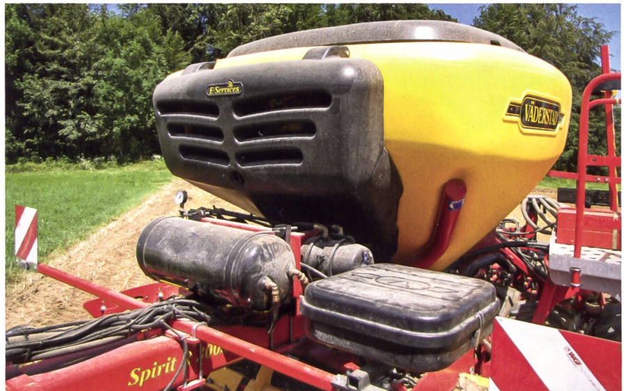
Das Gebläse ist vorne im Kunststofftank integriert. So soll wenig Staub angesaugt werden, und alle Teile sind gut geschützt.
