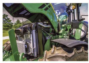
Der 4-Zylinder-Motor von John Deere erfüllt die Abgasnorm der Stufe 3b und wird nur mit Diesel betrieben.
