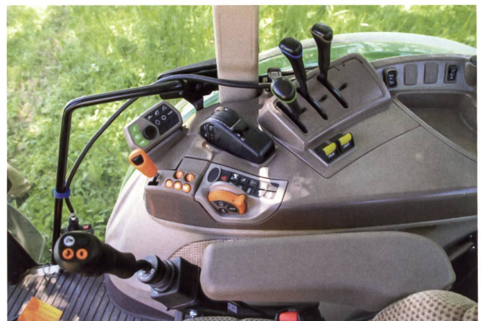
Einstiegsvariante mit mechanischen Steuergeräten und mechanischem Frontlader-Joystick am Fahrersitz.
