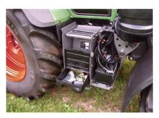
Die Batterie und der Werkzeugkasten sind gut zugänglich bei den rechten Einstiegsstufen untergebracht.
