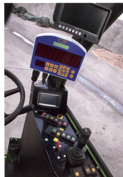
Alle Funktionen werden über die Konsole auf der rechten Sitzseite bedient.
