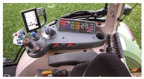
Die nach Farben logisch geordneten Bedienungselemente sind alle in die Seitenkonsole integriert. Der Bildschirm ist in dieser Version eher etwas klein.
