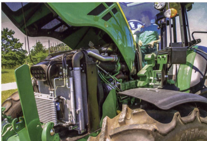
Der 4-Zylinder-Motor von John Deere erfüllt die Abgasnorm der Stufe 3b und wird nur mit Diesel betrieben.
