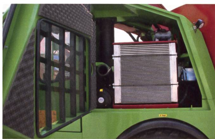
Der Kühler und der Luftfilter sind unmittelbar hinter der Kabine positioniert.
