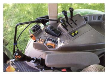
Einstiegsvariante mit mechanischen Steuergeräten und mechanischem Frontlader-Joystick am Fahrersitz.
