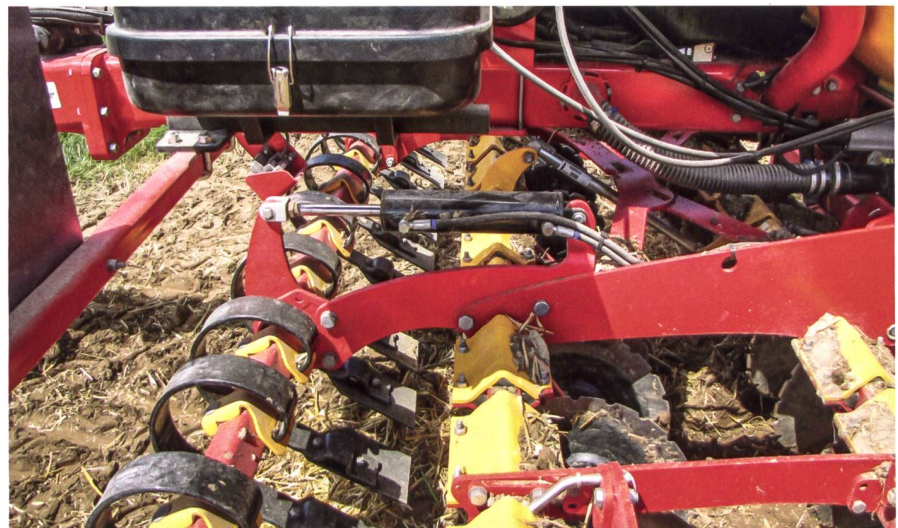
Die Werkzeuggruppen Scheibenegge, Crossboard, Säschare und Nachstriegel können jeweils über einen Hydraulikzylinder von der Kabine aus verstellt werden.
