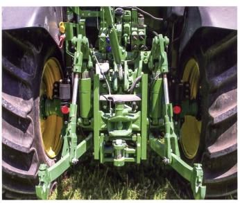
Über die Heckhydraulik stemmt der neue «5R» 4,7 t und optional sogar bis zu 5,3 t.
