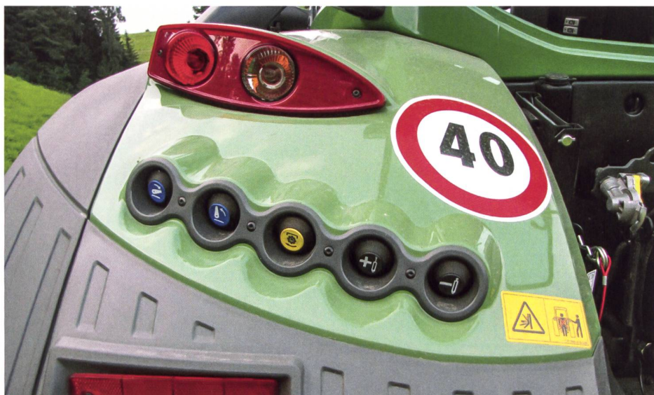
Hubwerk, Zapfwelle und ein beliebig wählbares Steuergerät lassen sich von extern bedienen.
