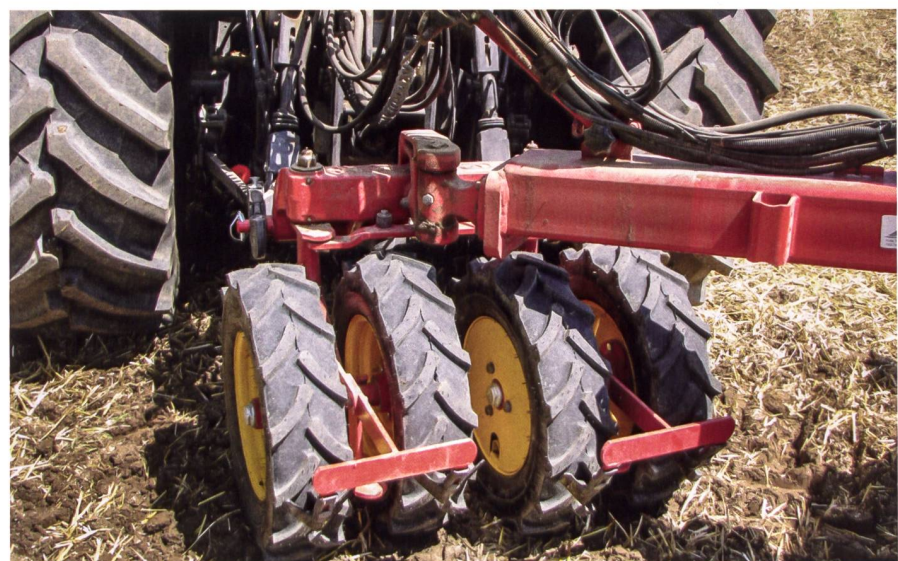
Mit der Option «Anhängung am Hubwerk» und «Zwischenradpacker» liegt der Drehpunkt weit hinten, was eine verbesserte Wendigkeit ermöglicht.
