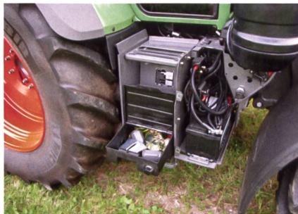
Die Batterie und der Werkzeugkasten sind gut zugänglich bei den rechten Einstiegsstufen untergebracht.
