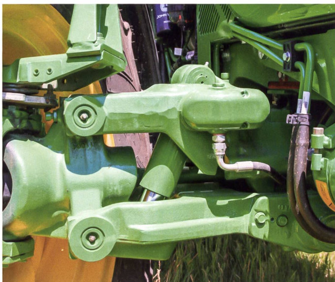
Die Einzelrad-Vorderachsfederung von Carraro lässt sich bei Bedarf sperren und manuell rauf- und runterfahren.
