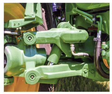
Die Einzelrad-Vorderachsfederung von Carraro lässt sich bei Bedarf sperren und manuell rauf- und runterfahren.
