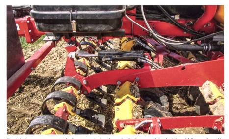
Die Werkzeuggruppen Scheibenegge, Crossboard, Säschare und Nachstriegel können jeweils über einen Hydraulikzylinder von der Kabine aus verstellt werden.
