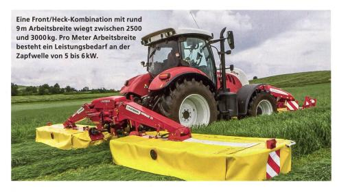
Hälfte einer Scheibenmähwerk-Kombination beträgt, können wesentlich leichtere Traktoren und auch Zweiachsmäher eingesetzt werden.
