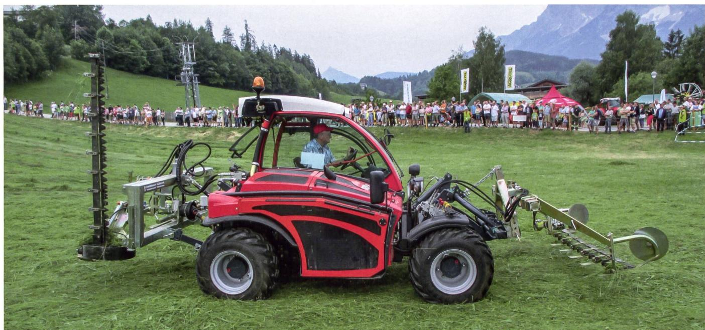
Der Leistungsbedarf an der Zapfwelle ist bei einer Doppelmesser-Front/Heck-Kombination mit bis zu 10,25 m Arbeitsbreite wesentlich tiefer als bei einer Scheibenmähwerk-Kombination und beträgt etwa 1,85 kW/m.
