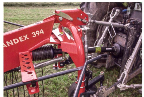
Der Schwenkbock arretiert automatisch, sobald die Maschine ausgehoben wird, und verhindert damit ein talseitiges Pendeln.
