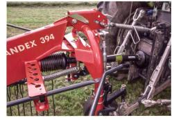
Der Schwenkbock arretiert automatisch, sobald die Maschine ausgehoben wird, und verhindert damit ein talseitiges Pendeln.
