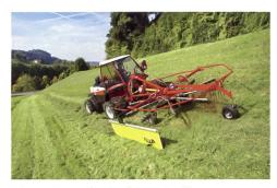
Mit starrem Anbaubock besteht die Möglichkeit, leichte Kreiselschwader im Frontanbau einzusetzen.
