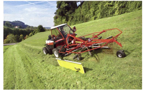
Mit starrem Anbaubock besteht die Möglichkeit, leichte Kreiselschwader im Frontanbau einzusetzen.
