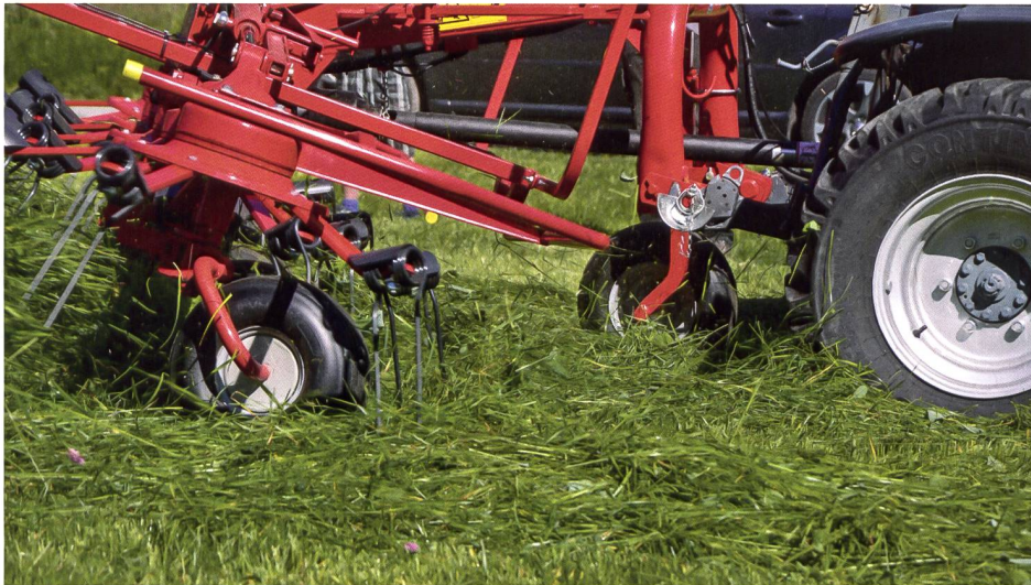
Durch das Verstellen der Radarme wird die Kreiselneigung beim «Giroheuer» von Kuhn an die Anforderungen des Mähgutes angepasst.
