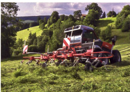
Kreiselheuer für alpine Gebiete sollen kurz und kompakt gebaut sein. Im Bild ein Lely «Alpine».
