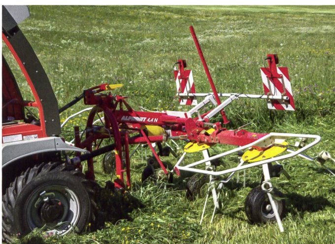
Schutzbügel, Signalisation und Beleuchtung sind sicherheitsrelevante Bauteile, die der Unfallverhütung dienen. Im Bild: Pöttinger «Alpinhit».
