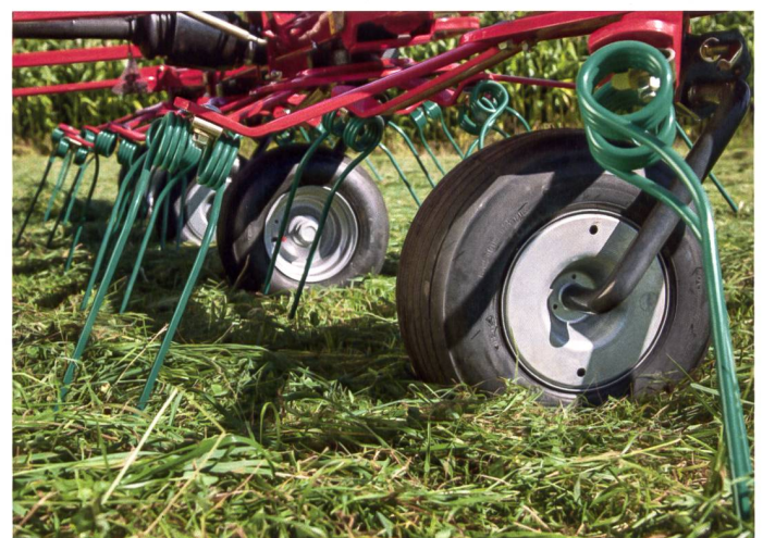
Je näher am Flugkreis der Zinken die grossvolumigen Räder laufen, desto besser ist die Boden-anpassung.
