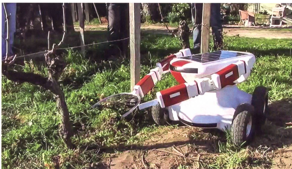
Der Roboter «Vin» soll so weit gediehen sein, dass dieser die Reben schneiden, auslichten, aufbinden und Informationen zum Gesundheitszustand liefern kann. Bild: Wall-ye
