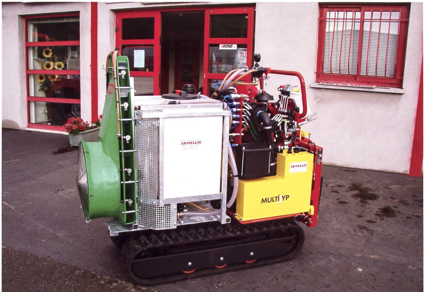
Kleine Raupenfahrzeuge sind leicht zu lenken und zu bedienen. Deshalb erleichtern sie viele Arbeiten im Rebberg und tragen dazu bei, die Produktionskosten auch auf Steillagen und Kleinparzellen zu senken. Bild: armellie.com
