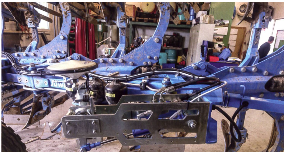
Der Empfänger muss am Pflug so angebracht werden, dass er auch beim Wenden geschützt bleibt.
