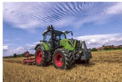
Fendt hat die Traktorenbaureihe «500 Vario», die sich im Leistungsbereich von 125 bis 165 PS bewegt, einem Update unterzogen. Abgesehen von der Erfüllung der Abgasnorm der Stufe 4, welche die eingebauten 4,04-l-Motoren von Deutz mit elektronisch geregelter Abgasrückführung, SCR-Technik und Partikelfilter erfüllen, bekommen die vier neuen Modelle («512», «513», «514» und «516») die «Visio-Plus»-Kabine und können von Optionen aus dem Grossstraktorsegment profitieren. Darunter befindet sich das
