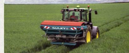
Sulky erweitert die Ausstattung seiner Anbau-Düngerstreuer von Typ «X40+» und «X50+». Zu den neuen Ausrüstungen gehört eine neue, hydraulisch zu bedienende Abdeckplane mit Aufrollmechanismus (Standard). Weiter steht ein zentraler, ebenfalls hydraulisch zu bedienender Grenzstreuenschirm als Sonderausstattung bereit. Diese
