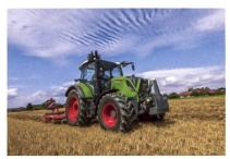
Fendt hat die Traktorenbaureihe «500 Vario», die sich im Leistungsbereich von 125 bis 165 PS bewegt, einem Update unterzogen. Abgesehen von der Erfüllung der Abgasnorm der Stufe 4, welche die eingebauten 4,04-l-Motoren von Deutz mit elektronisch geregelter Abgasrückführung, SCR-Technik und Partikelfilter erfüllen, bekommen die vier neuen Modelle («512», «513», «514» und «516») die «Visio-Plus»-Kabine und können von Optionen aus dem Grosstraktorsegment profitieren. Darunter befindet sich das
