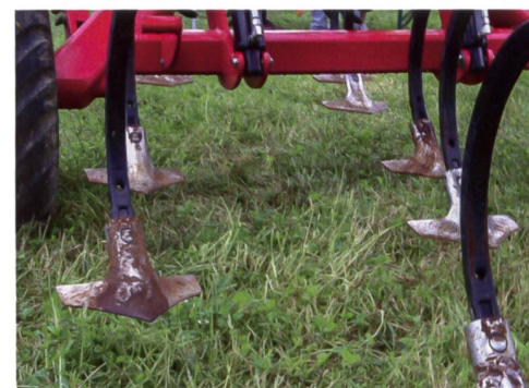
Die flachen Gänsefusssscharen erlauben einen pflugfreien Wiesenumbau und eine ganzflächige Stoppelbearbeitung nach Raps und Getreide. Tiefenführungsräder erlauben die genaue Einhaltung von 4–6 cm Arbeitstiefe. Bild: Quentin Morel
