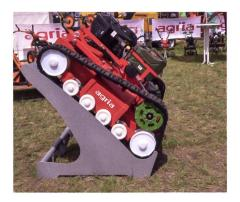
zept überzeugt. Dank einem extrem tiefen Schwerpunkt ist die Maschine in Hanglagen bis 50° (120%) einsetzbar. Das Raupengerät mäht in beiden Fahrrichtungen bis maximal 10 km/h, unterteilt in drei Geschwindigkeitsbereiche. Die pendelnd aufgehängten Messer erlauben das Mähen in beiden Fahrrichtungen, das heisst, ohne Wendemanöver. Alle Funktionen lassen sich per Fernbedienung steuern. Die Einsatzbereiche sind Hanglagen allgemein, Böschungen an Gleisanlagen und Autobahnen.
