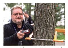
typ vorgestellt wurde. Hintergrund der Entwicklung ist, dass für das Messen von liegendem und stehendem Holz bislang immer eine typische mechanische Kluppe (im Foto) mitgeführt werden muss – und die ist gross und sperrig. Die von Udo Schmidt von Firma Grube auf der Messe vorgestellte Kluppe passt dagegen bequem in die Jackentasche und ermöglicht das spontane Messen von Holz mithilfe dreier Laserpunkte, mit denen über eine Winkelformel die Stärke des Holzes er-
