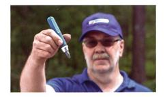
kaltem Wetter. Das Unternehmen HM Frästechnik aus der Nähe von Göppingen hat einen Halter aus Aluminium entwickelt, bei dem mit einer Drehbewegung die Kreide hinein- und wieder herausgefahren werden kann. Erhältlich ist er für knapp 30 Euro.
