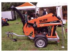
rarotsensor wahrnimmt, wenn sich der Anwender vom Einfuhrtrichter entfernt. Begibt sich die bedienende Person wieder zurück an den Arbeitsplatz, schaltet das System den Motor wieder auf volle Leistung. Benzinverbrauch und Abgase werden somit im passiven Betriebszustand tief gehalten.
