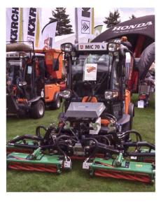
liche Gerät kann mit einem Pkw-Führerschein gefahren werden. Mit 73 dB ist der Geräuschpegel im Innern der ergonomisch gestalteten Kabine relativ niedrig. Dank langem Radstand soll der «Mic 70» auch bei schnellen Transportfahrten eine hohe Laufruhe aufweisen.
