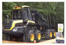
Ponsse «Buffalo». Durch diesen für Forwarder neuartigen, dreiteiligen Fahrzeugrahmen wird die Fahrerkabine auch bei starken Bodenunebenheiten immer in einer waagerechten Position gehalten. Die Kabine wird im Vorderwagen pendelnd gelagert und die dazugehörige Boogie-Achse aktiv nivelliert.
