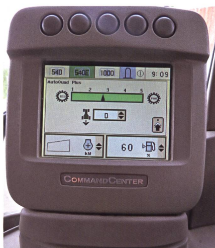
John-Deere-«PowerQuad Plus»-Getriebe: Einstellung der Drückung in den vier Lastschaltstufen. Hier von 1 bis 5 einstellbar (grüner Balken).
