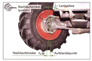
Neben Spreizung und Lenkrollradius ist der Nachlauf eine entscheidende Grösse, welche die Rückstellkräfte einer Lenkachse beeinflusst.
