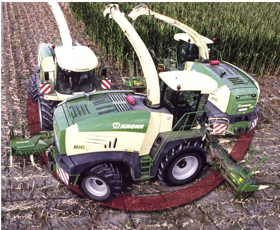
Feldhäcksler verfügen dank Hinterradlenkung über eine hervorragende Wendigkeit. Bild: Krone
