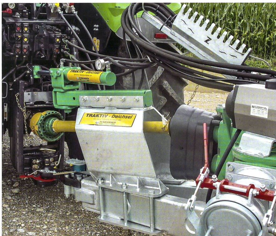
Die aktive Regelung entschärft die Gefahrenmomente bei Kurvenfahrten und belastet den Traktor gleichmässig. (Bild: Zunhammer)
