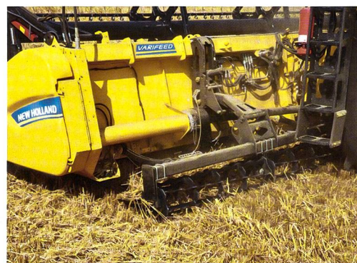
Gut sichtbar der gestufte Schnitt. Das herkömmliche Schneidwerk schneidet nur den oberen Teil des Getreidehalms.
