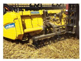
Gut sichtbar der gestufte Schnitt. Das herkömmliche Schneidwerk schneidet nur den oberen Teil des Getreidehalms.
