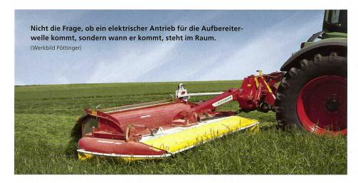
Mähaufbereiter erfordern hohe Antriebsleistungen: Zudem ist der Aufbereitungsgrad von der Drehzahl abhängig. Der mechanische Antrieb lässt diesbezüglich wenig Flexibilität zu. Bei kleiner Drehzahl ist die Wirkung kaum oder gar nicht vorhanden, mit einer hohen Drehzahl steigt der Leistungsbedarf, und die unerwünschten Bröckelverluste steigen je nach Futterbestand stark an.
