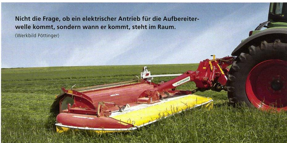
Mähaufbereiter erfordern hohe Antriebsleistungen: Zudem ist der Aufbereitungsgrad von der Drehzahl abhängig. Der mechanische Antrieb lässt diesbezüglich wenig Flexibilität zu. Bei kleiner Drehzahl ist die Wirkung kaum oder gar nicht vorhanden, mit einer hohen Drehzahl steigt der Leistungsbedarf, und die unerwünschten Bröckelverluste steigen je nach Futterbestand stark an.
