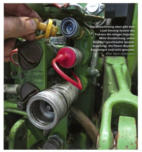
der Leitungsquerschnitt beim Rücklauf grösser dimensioniert ist, als bei der Druckleitung.
