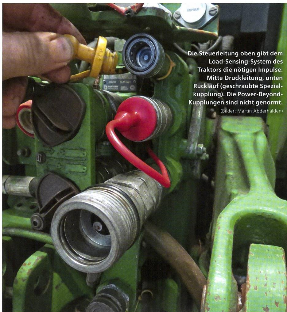
der Leitungsquerschnitt beim Rücklauf grösser dimensioniert ist, als bei der Druckleitung.
